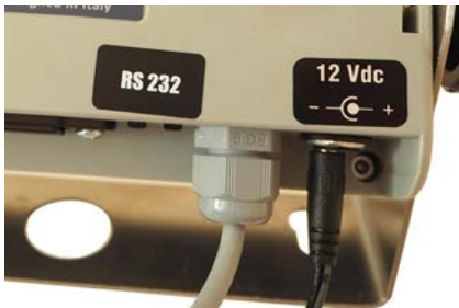
Anschlüsse an der Gehäuserückseite
