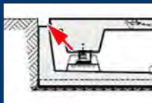
Abgesenkte Längsseiten für Betonfahrzeugwaage
