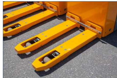
Verbindungsstrebe notwendig bei getrennten Gabelzinken
