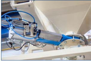
Schieber für exakte Dosierung
