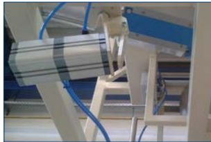
Pneum. Schlaufenhalter einfache Fixierung der Big-Bag-Schlaufen
