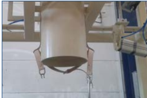
Füllstutzen mit Einhandsackschnalle Blähbalk (optional)
