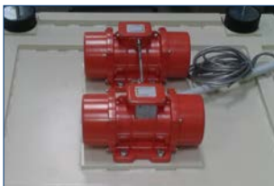
Unwuchtmotore für Rüttelfunktion zum Nachverdichten und vollständigen Befüllen
