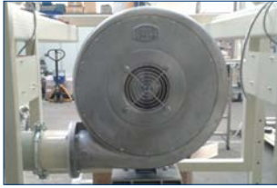
kombinierte Absaugung und Aufblasvorrichtung für staubfreie Umgebung
