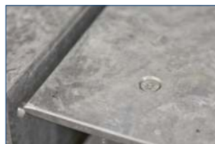
Lastplatte verschraubt versenkte Schrauben
